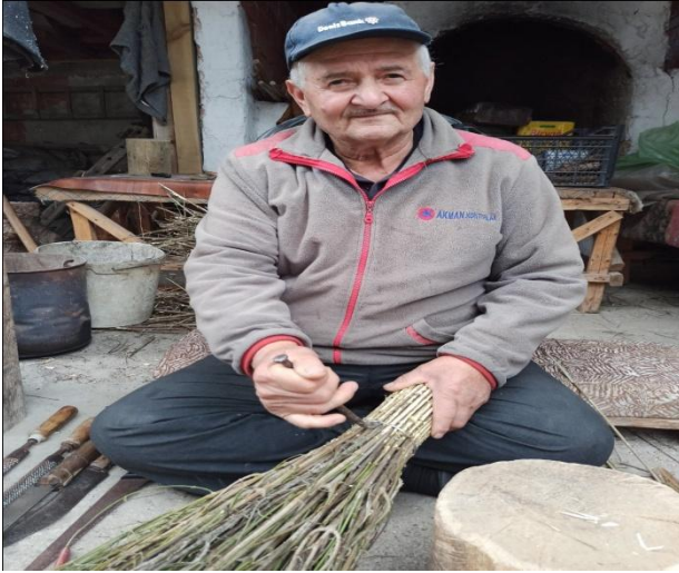
Fotoğraf 16: Demir Çubuk İle Sıkıştırma İşlemi ve Tel İle Bağlama Örneği
