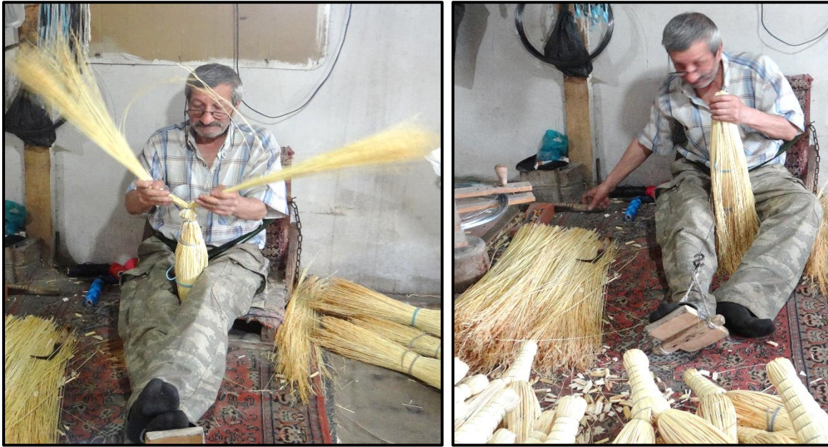
Resim 4. Süpürgenin Tepe Bağlama Aşamalarından Kesitler
