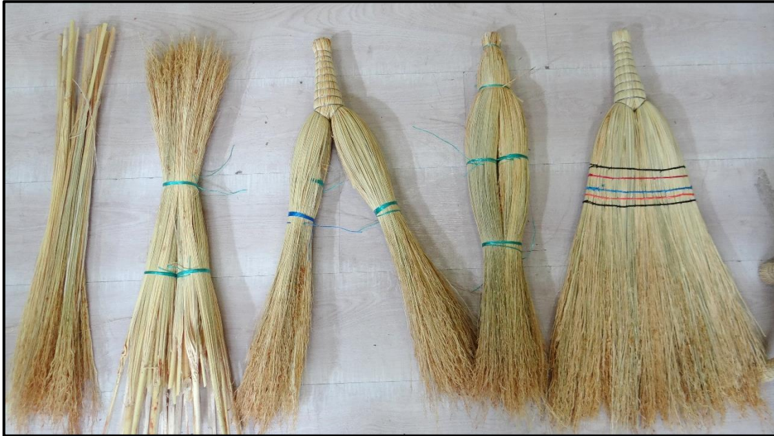
Resim 6. Tipik Bir Süpürgenin Yapım Aşamalardan Kesitler
