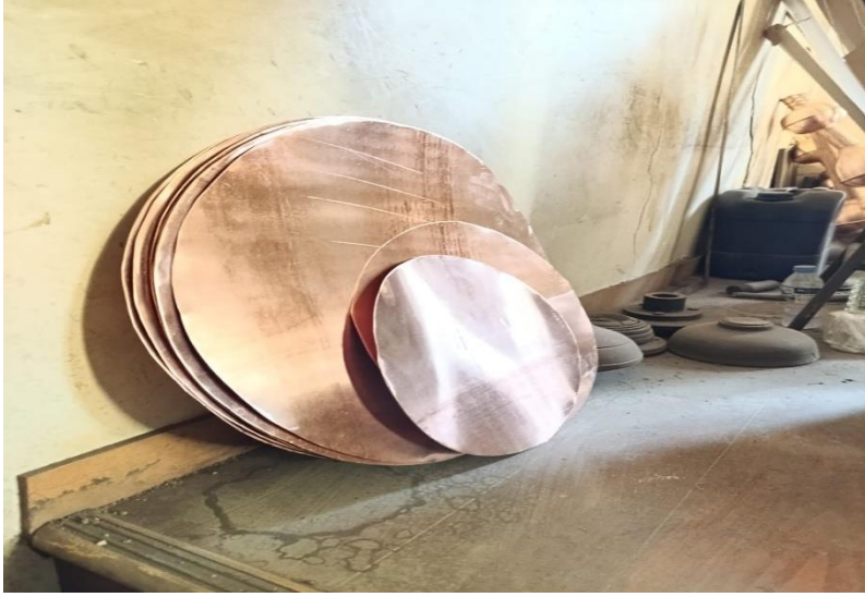
Resim 11: Alem Yapımında Kullanılan Bakır Levhalar
