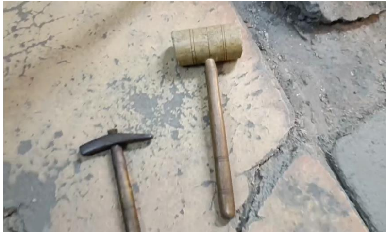
Resim 2: Alemin Yapımında Kullanılan Çekiç ve Tokmak
