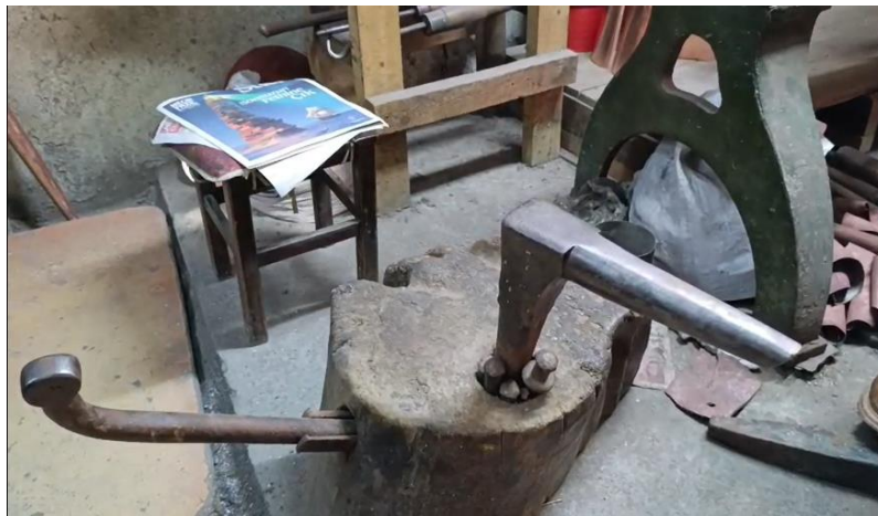
Resim 3: Alemin Yapımında Kullanılan Örs
