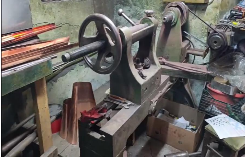
Resim 4: Alem Yapımında Kullanılan Tezgah
