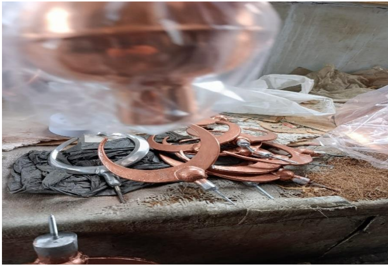
Resim 27: Döküm alem Uçları
